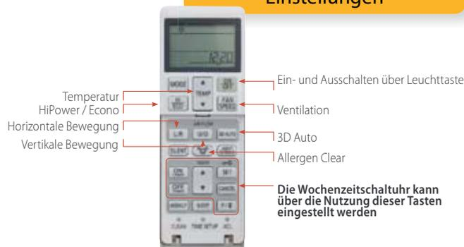
Die horizontale Bewegung begünstigt die Luftansaugung, verringert den Luftwiderstand und senkt leicht den Schalldruckpegel.
